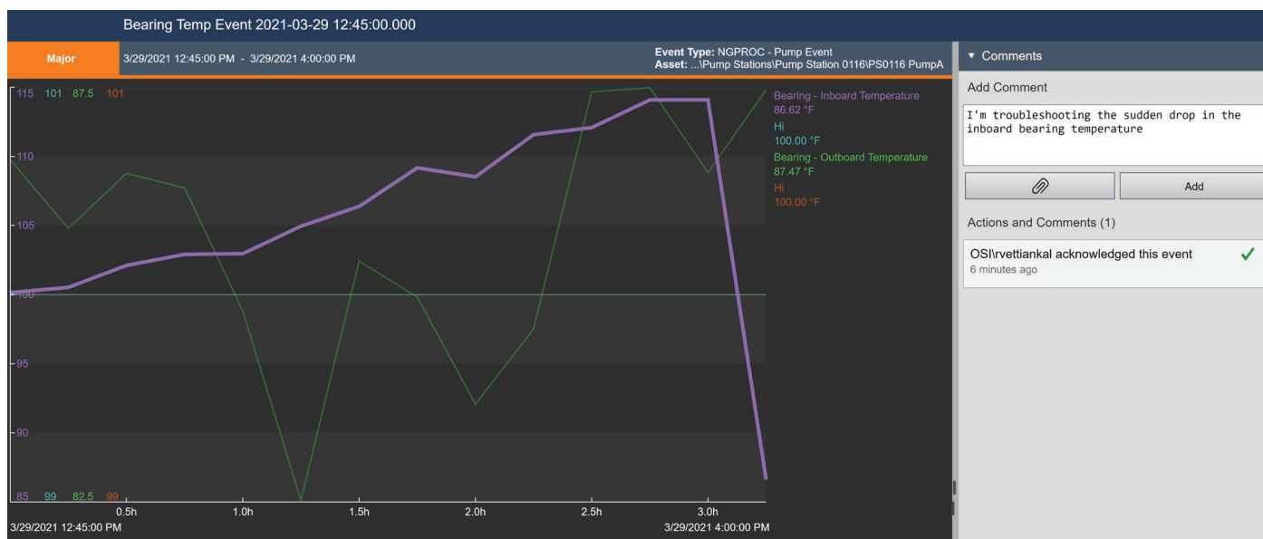
図2: このAVEVA PI Visionのイベント詳細画面は、ベアリング温度イベントと、イベントを構成する属性のトレンドを表示しています。この重大イベント (深刻度がオレンジ色) は駆動側ベアリング温度 (紫色のトレンド) の急低下により発生したと考えられます。ユーザーがイベントを確認し、コメントを付与し、イベントの解決中であることを関係者に知らせています。
