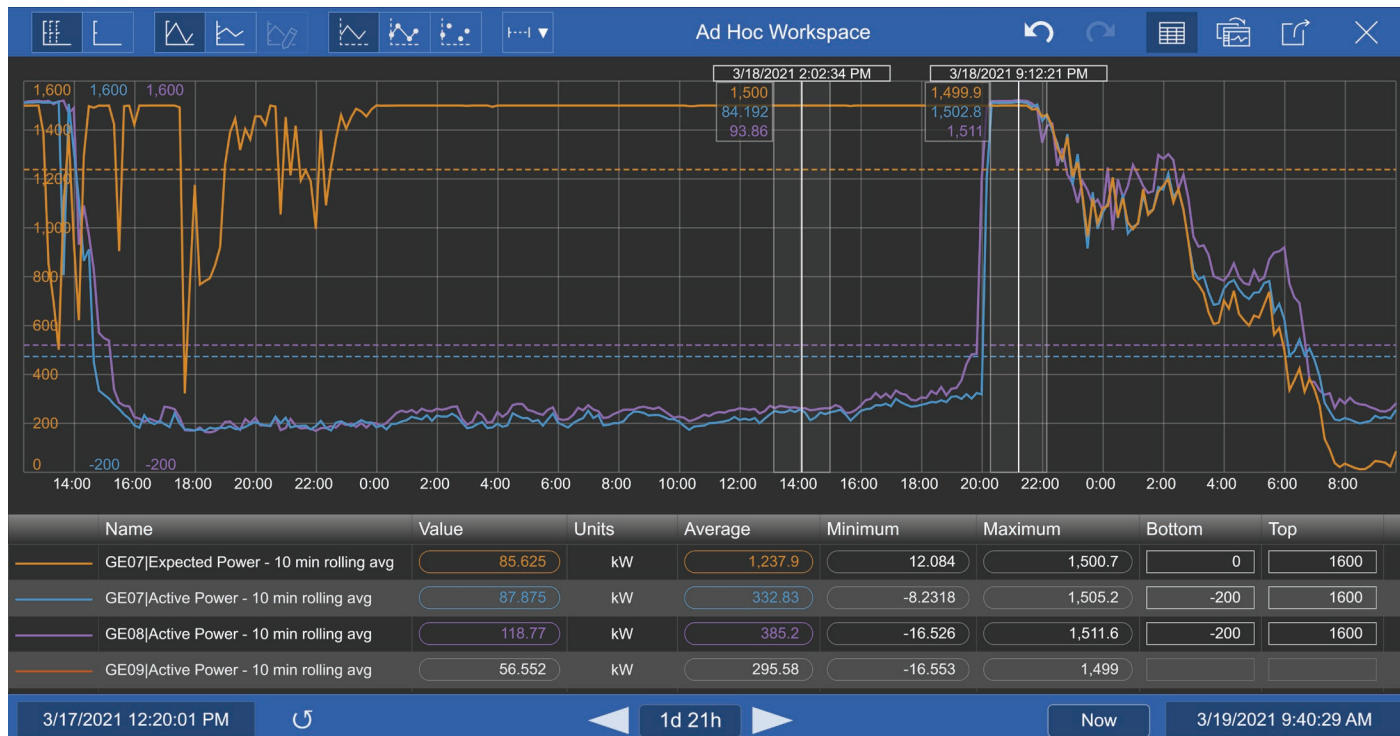
図3: AVEVA PI Visionのアドホックワークスペースに、3つの設備資産の有効電力の10分移動平均を追加しています。その3つに加え、3つのうち1つの設備資産の予想電力も追加しています。同じトレンド画面に一度に表示し、即座に分析して実際の状況と予想を比較できます。
